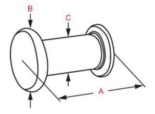
Référence Longueur (A) diamètre bouton (B) Diamètre tube (c) 4502/LA/30 30 mm 21 mm 12 mm 4502/LA/50 50 mm 21 mm 12 mm
